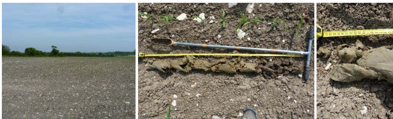
Figure 4 : Parcelle 3, Sondage R4, trace d'oxydation.
