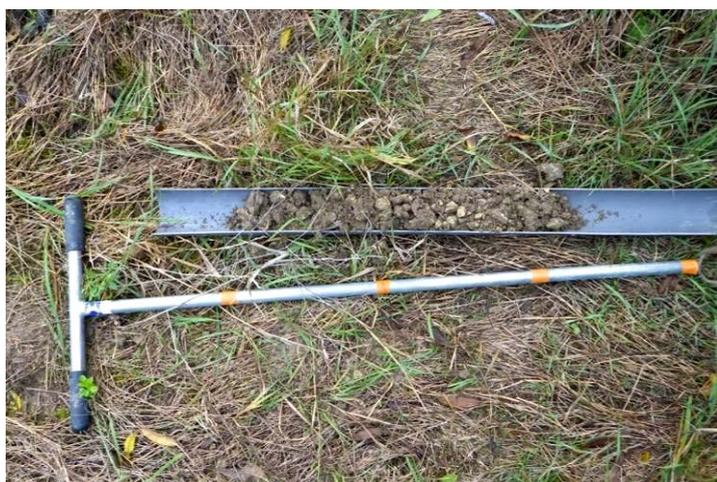
Le sondage révèle une fois encore un sol argilo-caillouteux et un refus de tarière à 25 cm : le contexte général de la zone semble être le même partout, avec un sol calcaire de groies, assez superficiel et très caillouteux, non caractéristique de zones humides. Aucune trace d'hydromorphie n'a été détectée. Adeline AIRD conclut en l'absence de zone humide.
