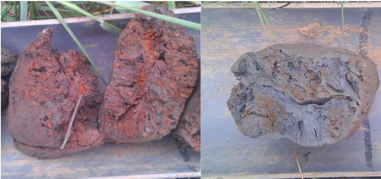
Zoom du sondage n°2 à 30 cm de profondeur à gauche (traits rédoxiques marqués) et 70 cm de profondeur à droite (traits réductiques).
