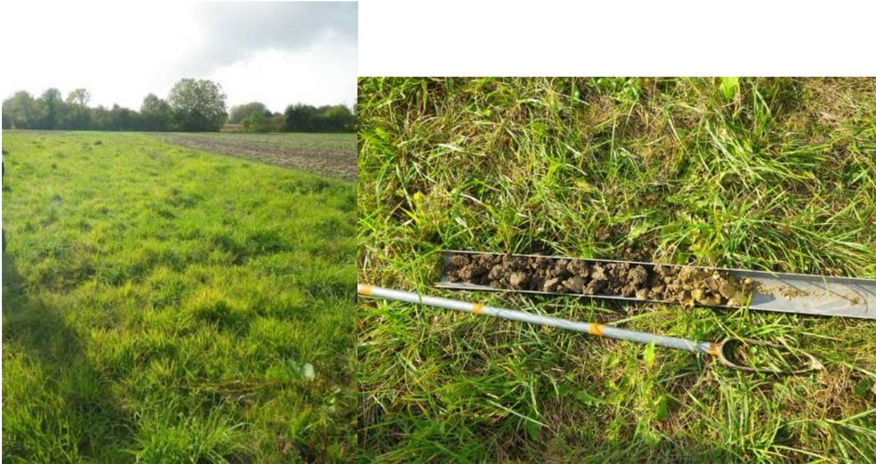
Figure 5 : Sondage pédologique réalisé dans une parcelle en prairie (profondeur de 65 cm)
