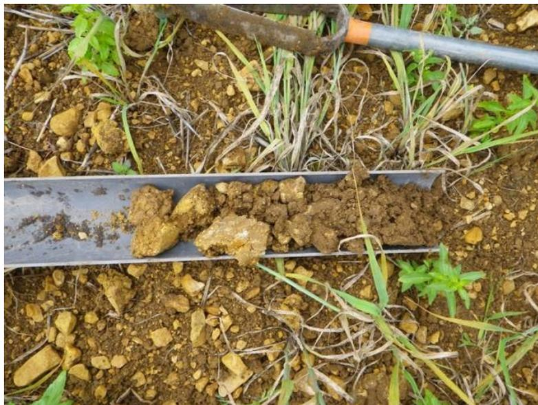
Figure 4 : Sondage pédologique réalisé dans une culture sur un sol de groie argilo-calcaire (profondeur de 40 cm)
