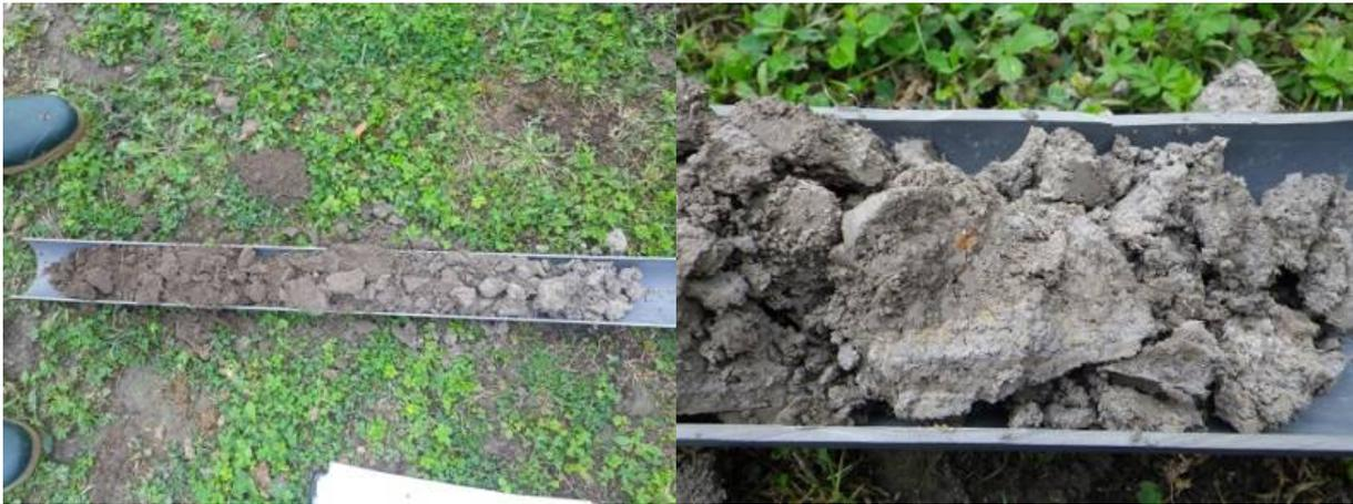
Figure 2 : A gauche, sondage pédologique réalisé dans la prairie pâturée (profondeur de 80 cm) - à gauche, zooms sur les traces de déferrification observées
